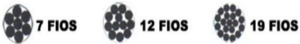
Figura 20 – Esquema de uma cordoalha
