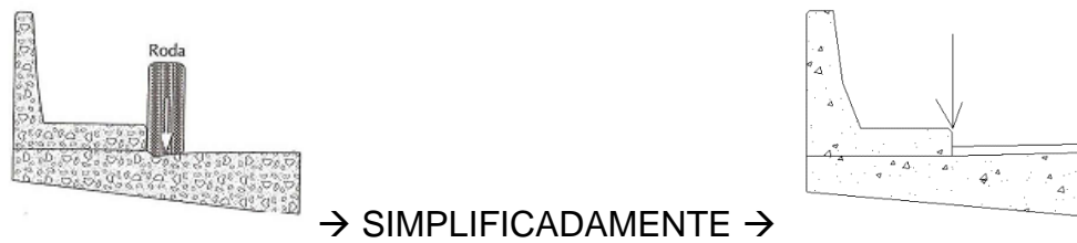
Figura 46 – Roda do veículo encostada no guarda-rodas
